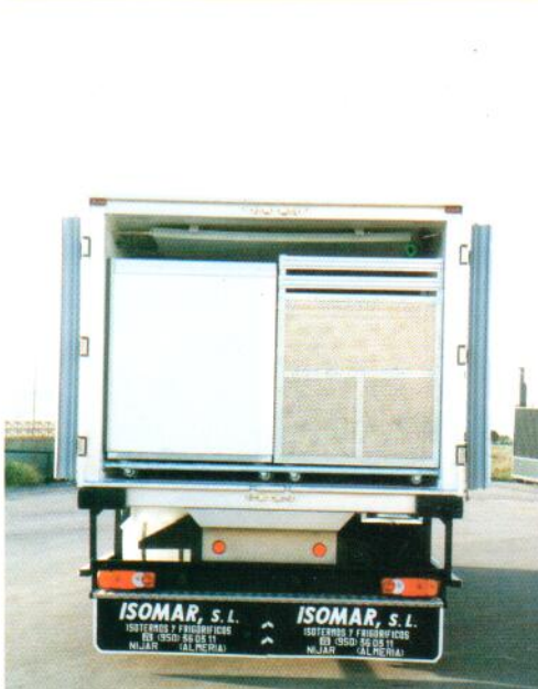
Furgón heladero con carritos interiores y cesta isotermo para material o mercancía no congelada.
