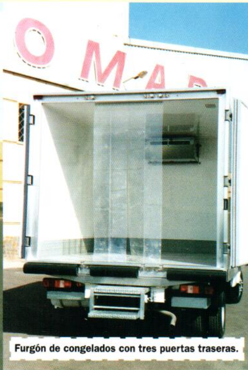
Furgón de reparto de congelado con tres puertas. La central con cortinas de lamas.
